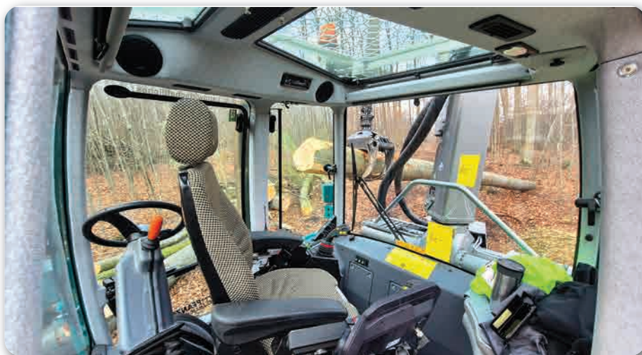
Az elektromosan 340°-ban elfordítható kezelőülés és a vele azonos irányban együtt forduló kezelőelemek
