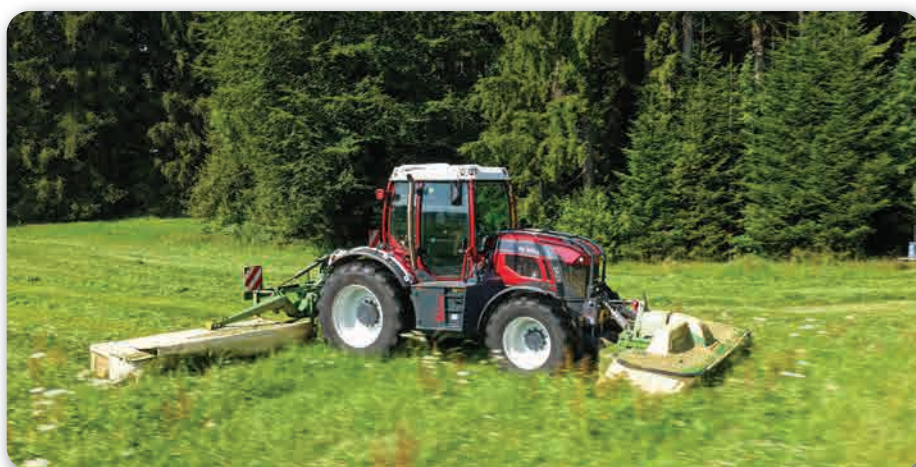
A Pfanzelt a Pm Trac-ot úgy tervezte, hogy az erdészeti felépítmény eltávolítása után a gép valamennyi fontos mezőgazdasági funkciója változtatás nélkül megmaradjon
