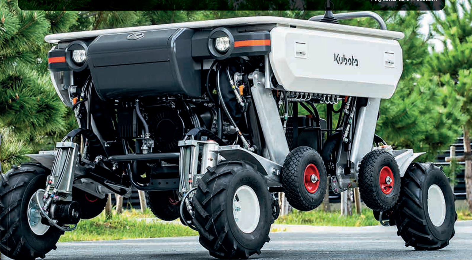
A Kubota minden terepre alkalmas All-Terrain platformot mutatott be lejtős és sziklás területeken végzett mezőgazdasági munkákhoz
