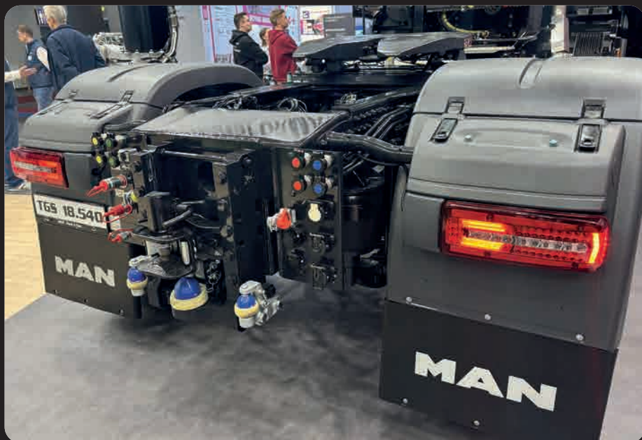
A TGS nyeregszerkezettel és konzolos pótkocsivonórendszerrel egyaránt fel van szerelve, így különféle szállítási feladatokra alkalmas
