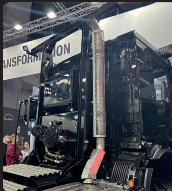
A MAN mezőgazdasági teherautó a fülke mögött ROPS borulásvédő kerettel is rendelkezik
