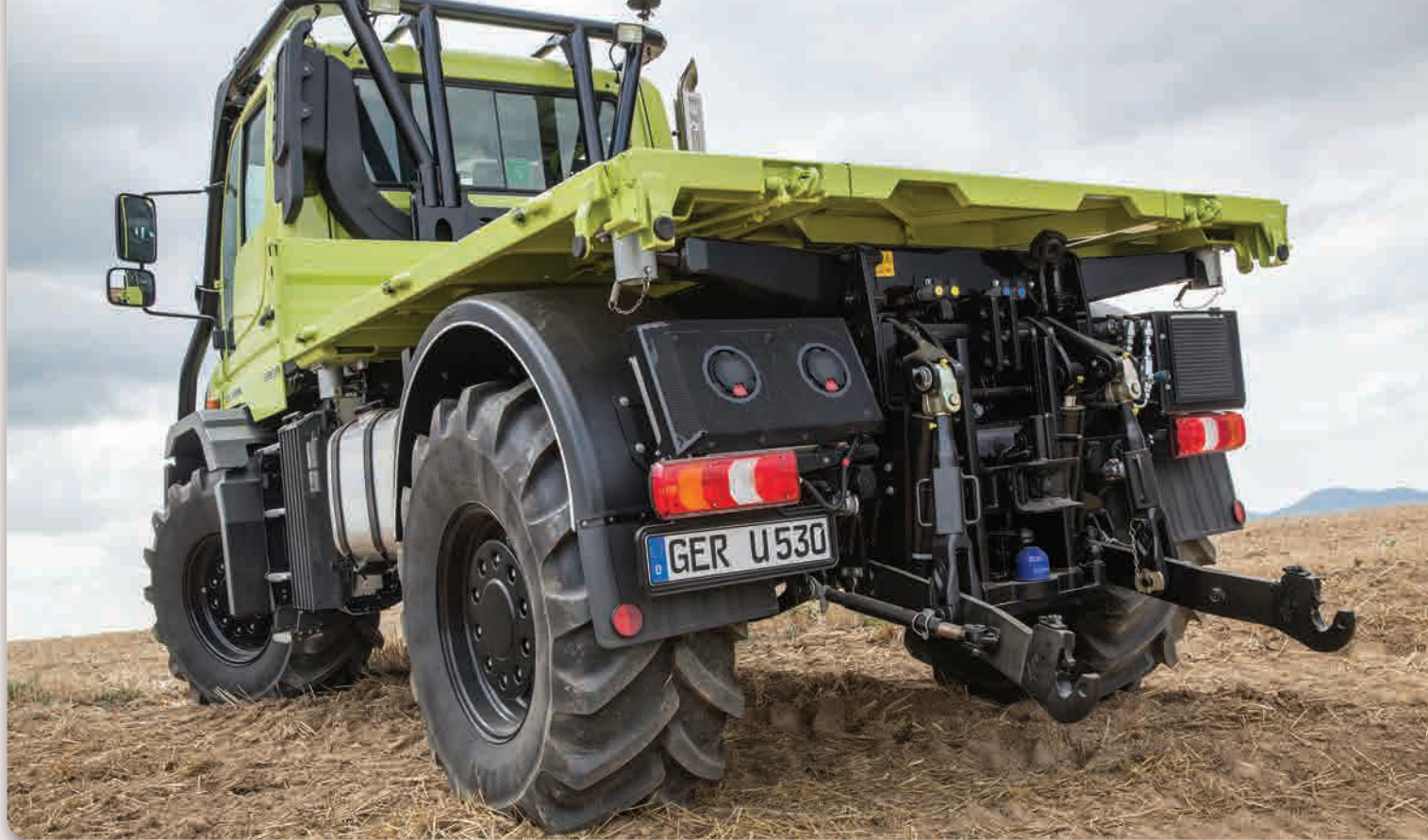
A hátsó emelőszerkezet helyzet- és erőszabályozású, valamint a mechanikus hátsó TLT teljes motorteljesítményt biztosít
