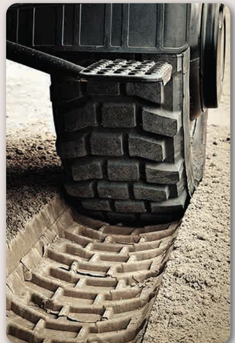
A guminyomás-szabályozó rendszer lehetővé teszi a nyomás módosítását szántóföldi és közúti használat között
