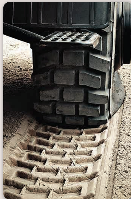
A guminyomás-szabályozó rendszer lehetővé teszi a nyomás módosítását szántóföldi és közúti használat között
