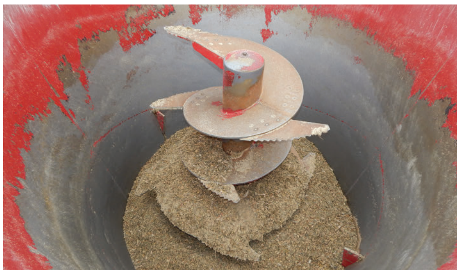
A takarmánykeverőben az optimális keverék minőségét az éles kések biztosítják (forrás: Horizont Média Kft.)
