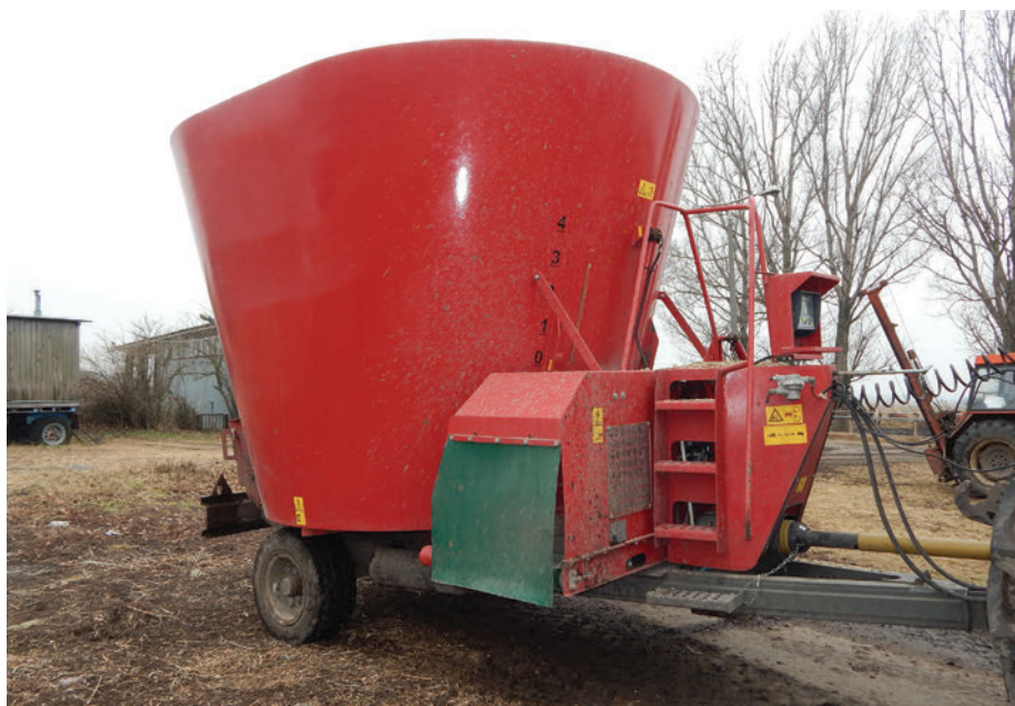
Téli időben hagyja a meghajtását tíz percre üresjáratban, mielőtt betölti a takarmányt, így a hajtóművekben lévő olaj lassan felmelegedhet (forrás: Horizont Média Kft.)
