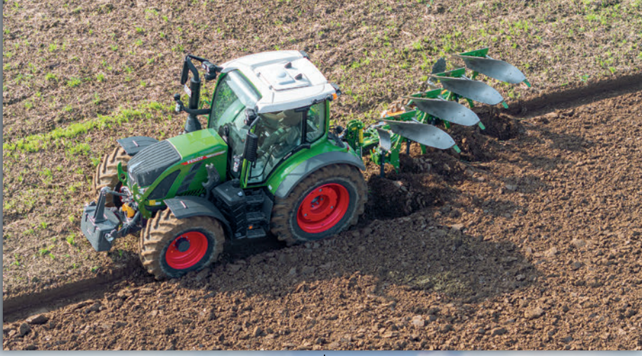
Zökkenőmentes csatlakozás, az elülső barázdászélesség helyes beállításának köszönhetően
