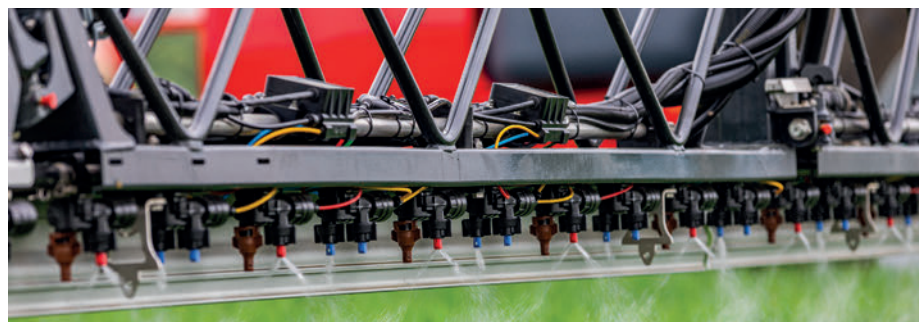
6. kép. LT, az eredeti Leeb 25 cm-es fúvókaosztás
