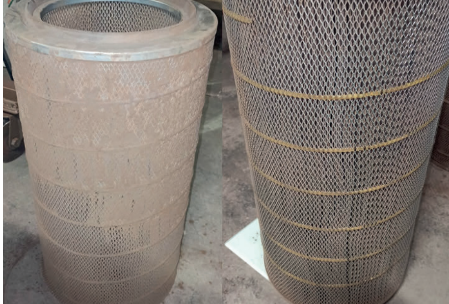
Légszűrő AFB-vel tisztítva, előtte utána állapot
