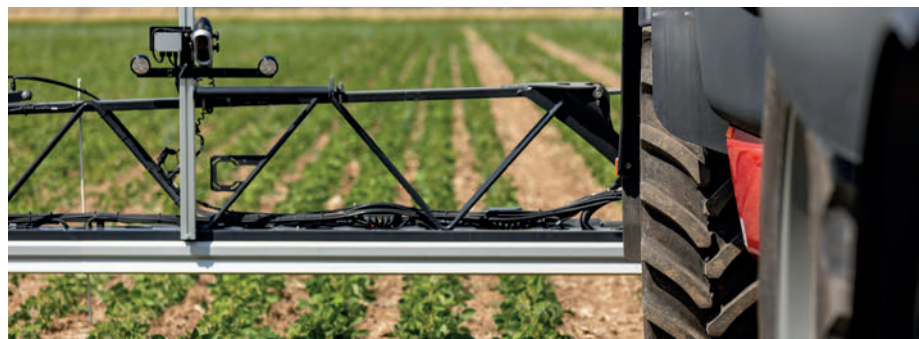
5. kép. Sávpermetezés – kamera által kormányzott Leeb 5 LT
