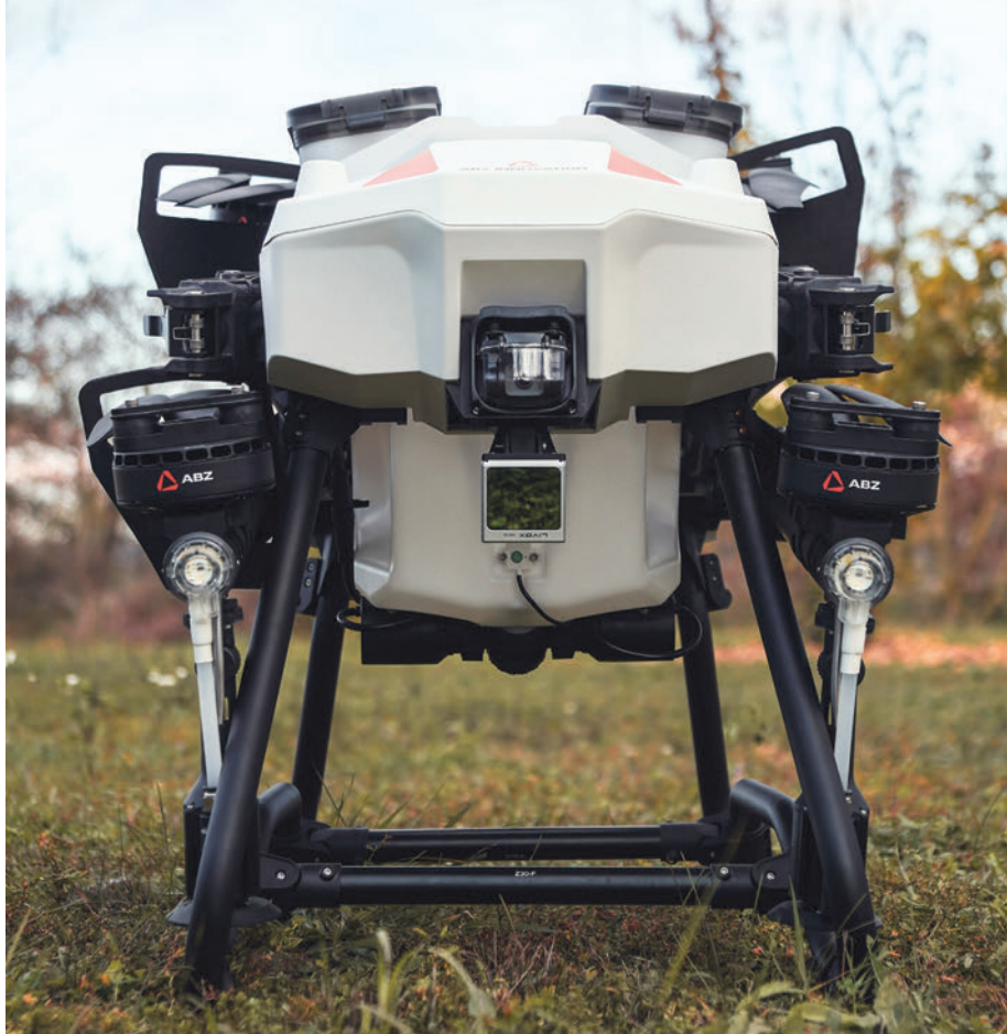
3. kép. A rotorok szállítási helyzetben behajthatók (forrás: Hungexpo)
